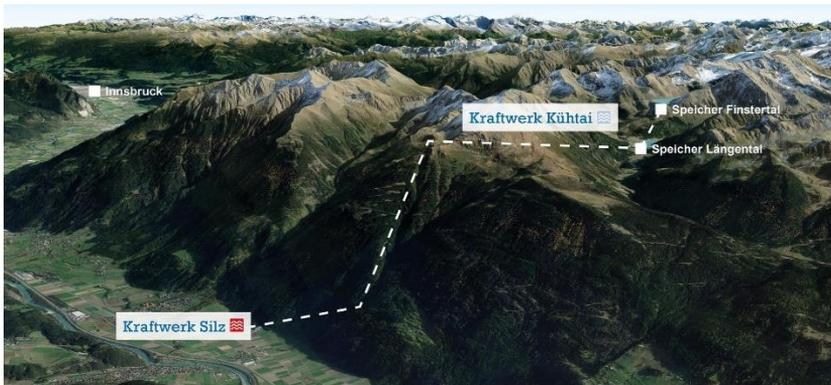
*Abb. 7: Übersicht über die Kraftwerksgruppe Sellrain-Silz mit dem Pumpspeicherkraftwerk Kühltai (Oberstufe) und dem Speicherkraftwerk Silz (Unterstufe).*
